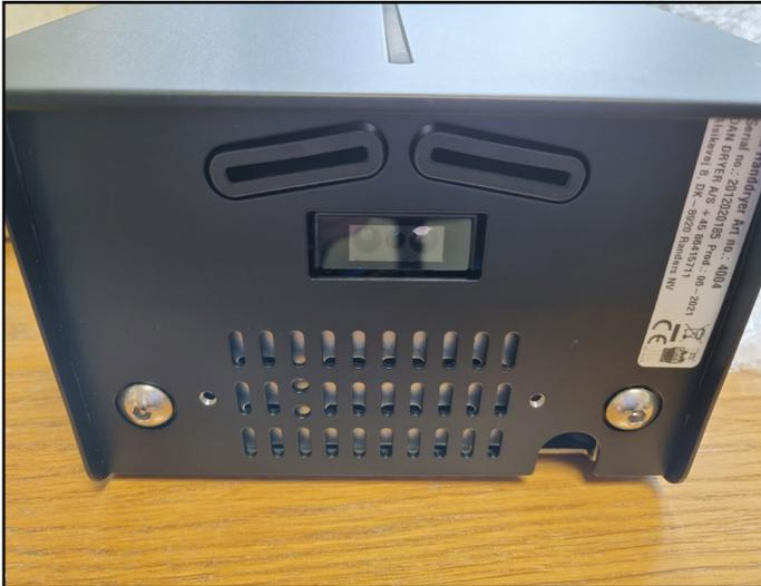
1. Die Montagelöcher beim Einlass des Produktes lokalisieren. Eventuell vorhandenes Filter vom Produkt vor der Montage des neuen Filters abmontieren.
